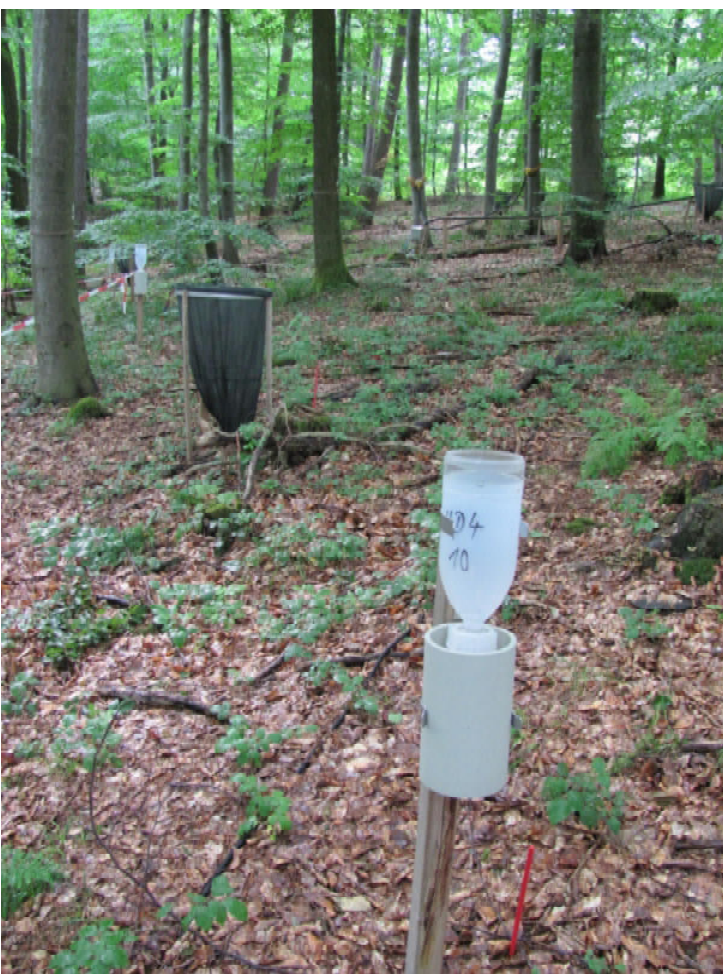
Abb. 24: Depositionsbehälter (Vordergrund) und Streusammler (Hintergrund) auf der Versuchsfeldfläche Heidelberg (Foto: A. Hölscher).
